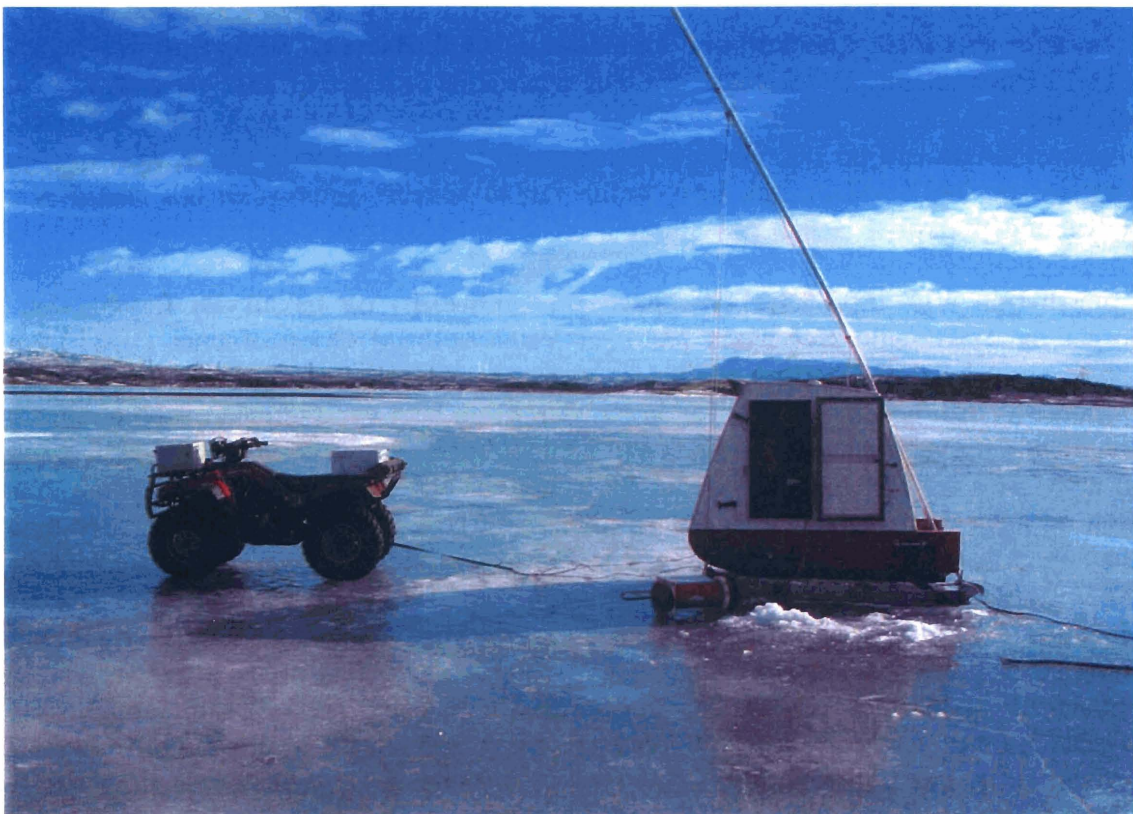
Mynd 1: Tæki sem notuð voru við straummælingar á Elliðavatni 20. mars 2002.
