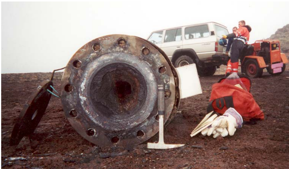
Mynd 12. Útfellingar í leiðslum frá holu 9 Reykjanesi. Myndin er tekin strax eftir blendu við hreinsun í júlí 2000, rennslisop er um 8 sm. Útfellingar eru aðallega ókristallaður kísill og járnoxíð (allt að 85%). Næst röri er sinksúlfíð, þá koparsúlfíð og blýsúlfíð (allt að 15%). Sýni 16, 17 og 18 í töflu 11.
