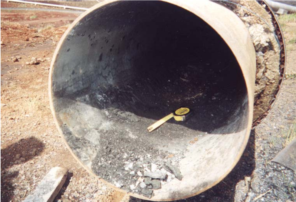
Mynd 15. Útfellingar, 3–6 cm þykkar, í leiðslum frá holu 9 Reykjanesi. Myndin er tekin um 150 m frá blendu við hreinsun í júlí 2000.
