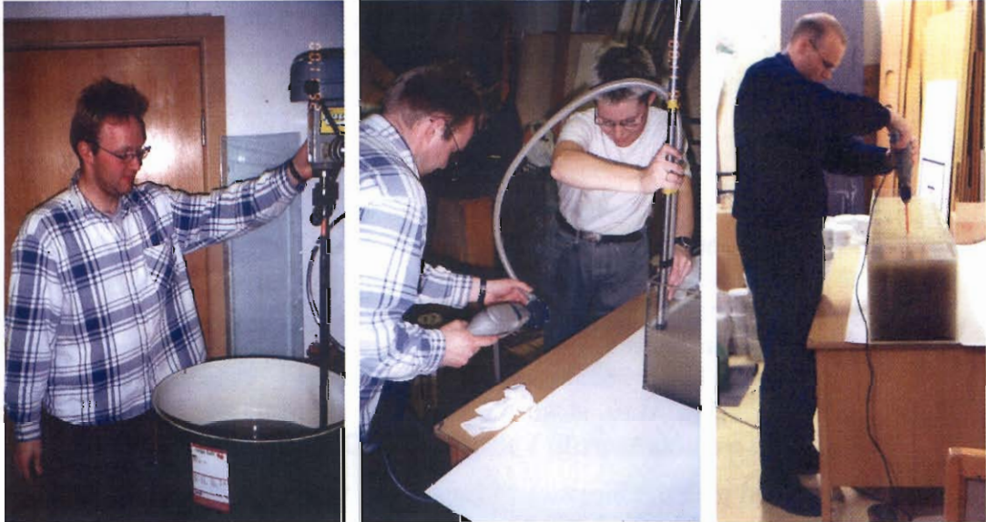
Mynd 4 Ljósmyndir frá tilraunum. a) Hrært upp í tunnusýnum með borðfastri borvél. b) Vatni dælt ofan af seti í plexiglerkeri. c) Hrært upp í plexiglerkerum fyrir útfellingu sets í fyrri hluta tilraunarinnar.
