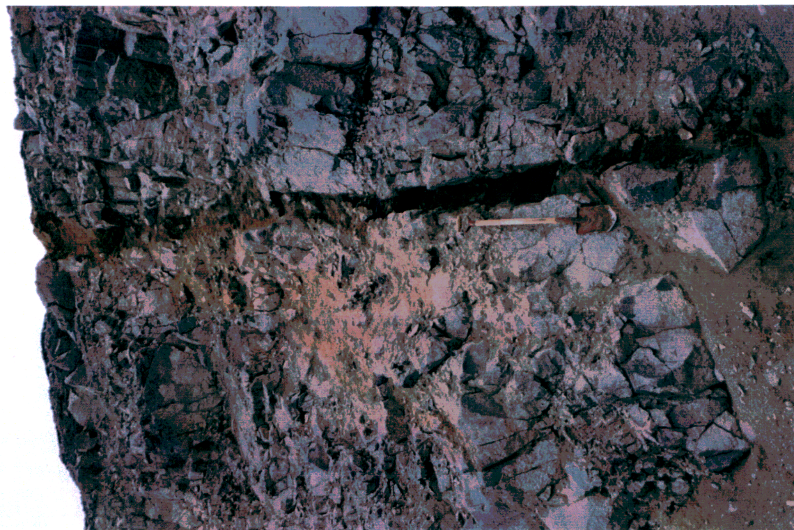
Mynd 8. Ljósmynd af sprungu nr. 7, jarðvegur hefur sigið niður í sprunguna.
