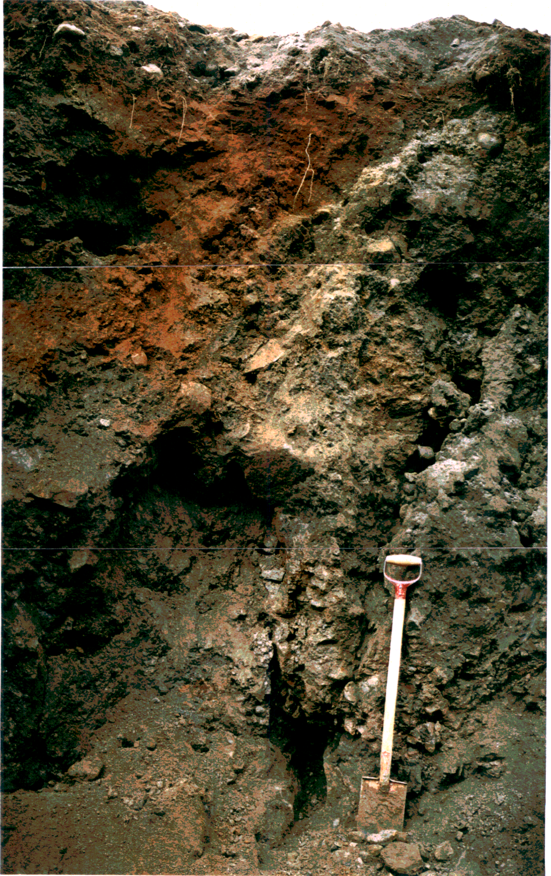
Mynd 13. Gryfja 1: Ljósmynd af sprungu 7, sprunga opin og jarðvegur hefur sigið niður í hana.
