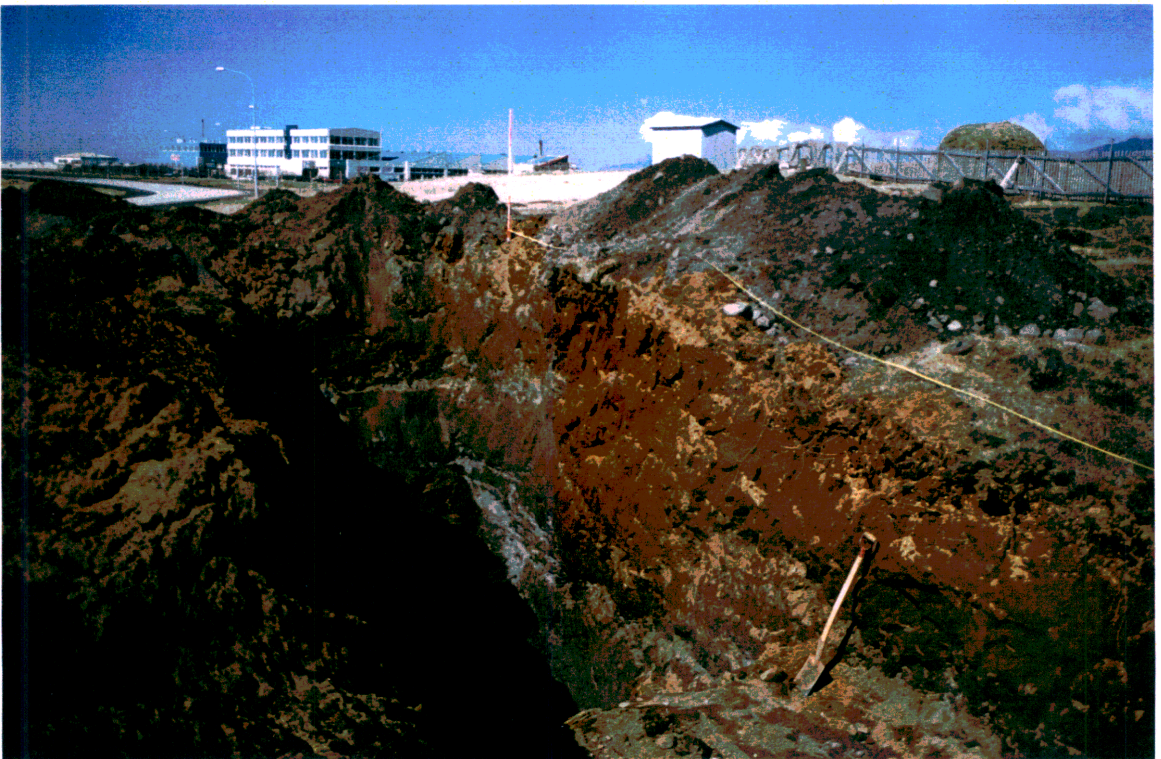
Mynd 12. Gryfja 2: Ljósmynd af sprungu 7, V-laga þykknun jarðvegs.
