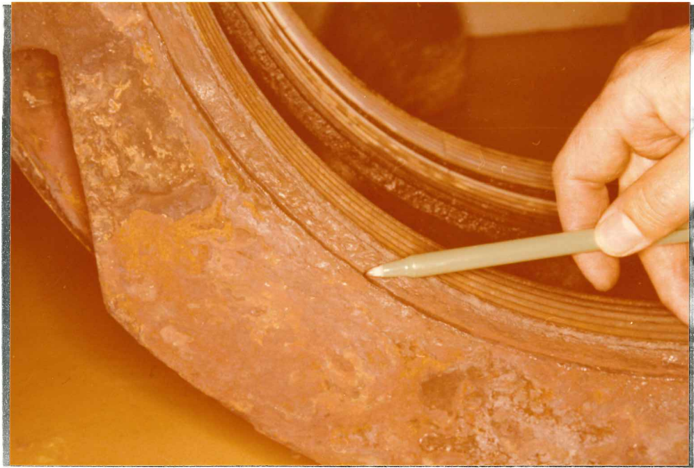
Mynd 105: Nærmynd af tæringu í hólfi milli áspéttiprepa, þar sem mætast gufa og loft.
