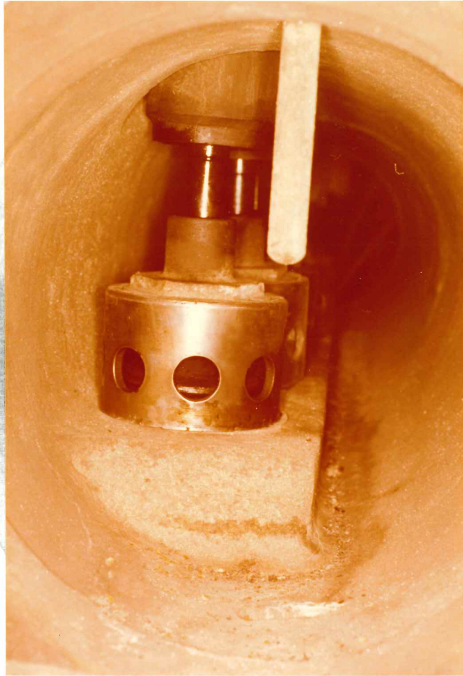
Mynd 4: Séð inn í gufukistu (inntak í stjórnloka).
