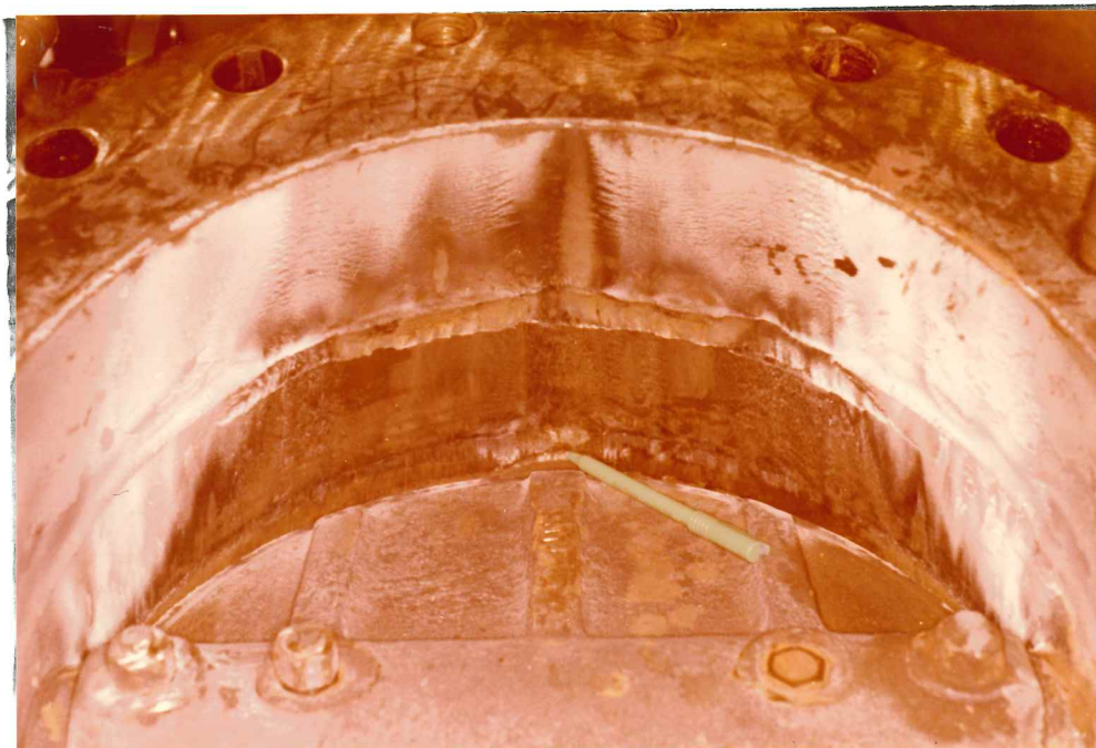
Mynd 51: Stjórnloki háþrýstigufu (útstreymismegin).
