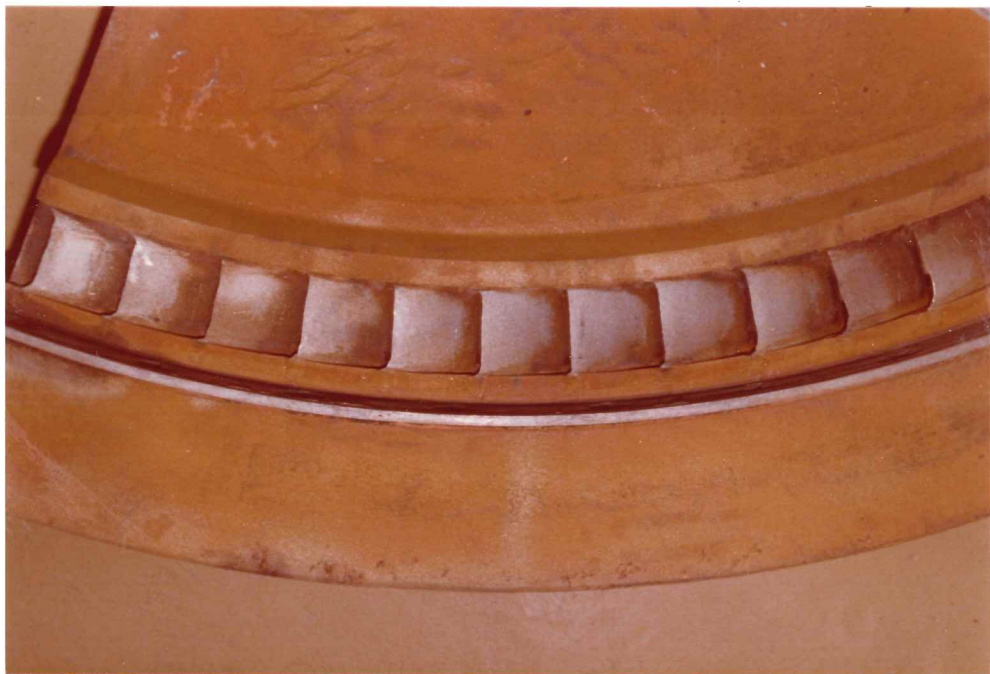
Mynd 115: Nærmynd af skóflum, þar sem engin gufa streymdi í gegn.
