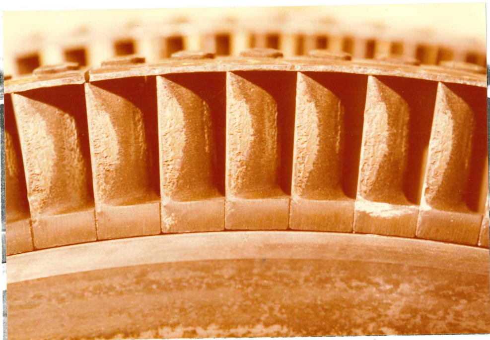
Mynd 11: 1. skófluröð á ás (innstreymi). Kísill var á frambrún.
