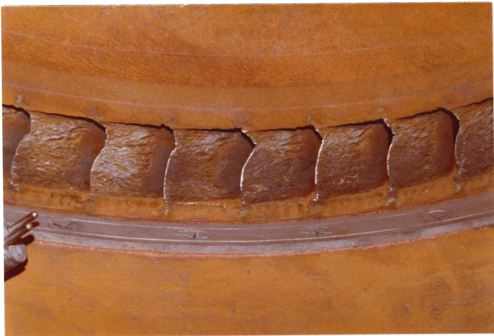
Mynd 117: Nærmynd af skóflum, þar sem gufustreymi var í gegn. Hvassar brúnir á bakkanti skóflanna voru sorfnar með þjöl.
