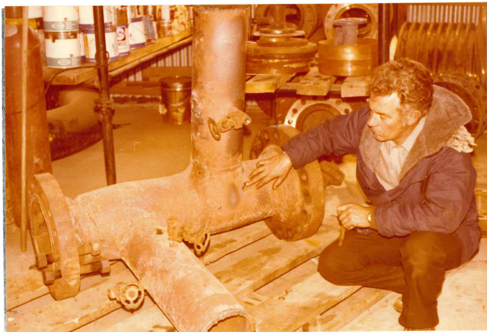
Mynd 2: Holutoppur KG-12 (eftir 5 1/2 mánuð).
