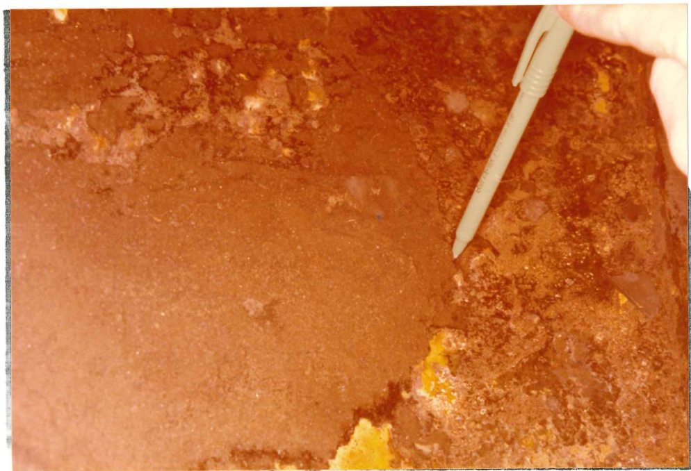
Mynd 42: Nærmynd af "sandi" í hábrýstisíuhúsi.
