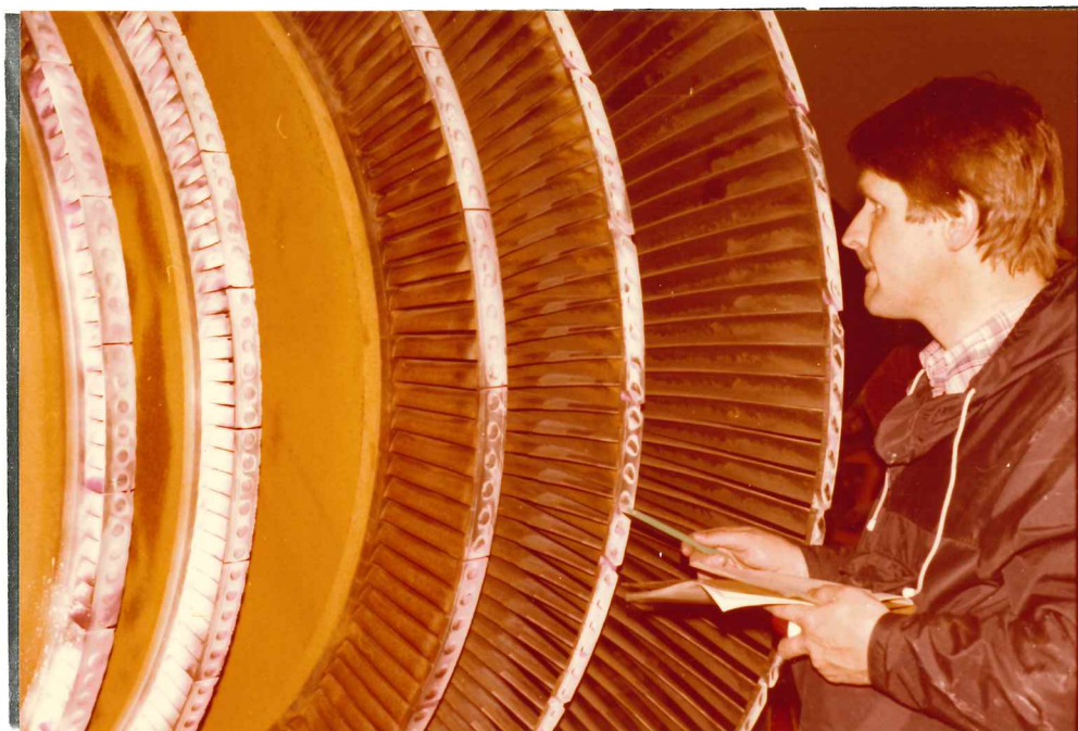
Mynd 63: Skóflur hverfiláss, þrep 1-5. (1 þrep lengst til vinstri.
