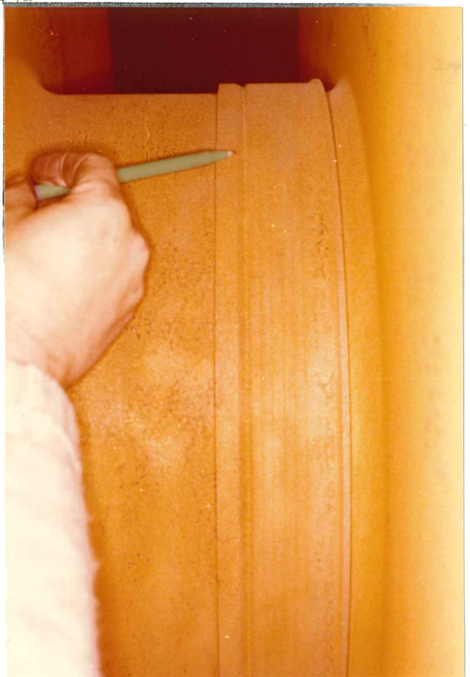
Mynd 78: Ás, milli 2. og 3. þreps. Bent er á slitrónd (erosion).
