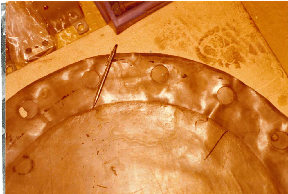
Mynd 110: Sprunga í blýmembru. (Springur, ef eimsvaþaprýstingur fer yfir ákveðið hámark).
