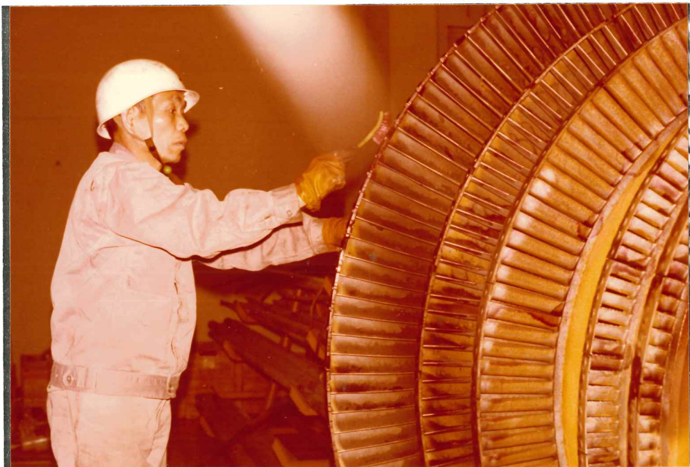
Mynd 62: Skóflur hverfiláss (þrep 1-5).
