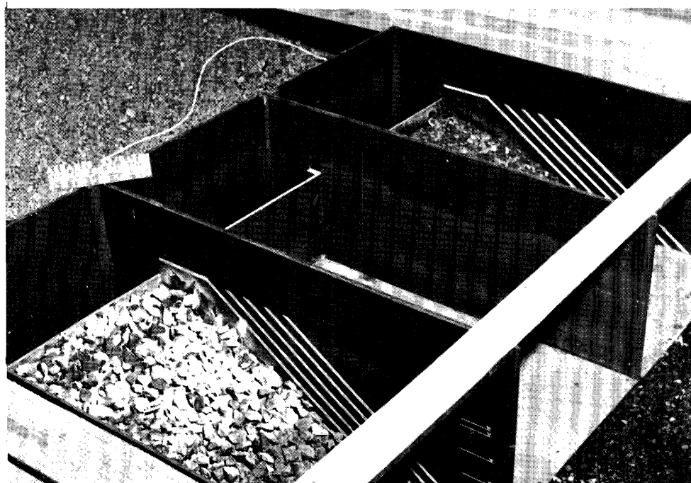
Líkantilraun Akraneshöfn. Stöðugleikaprófun grjótgarða
