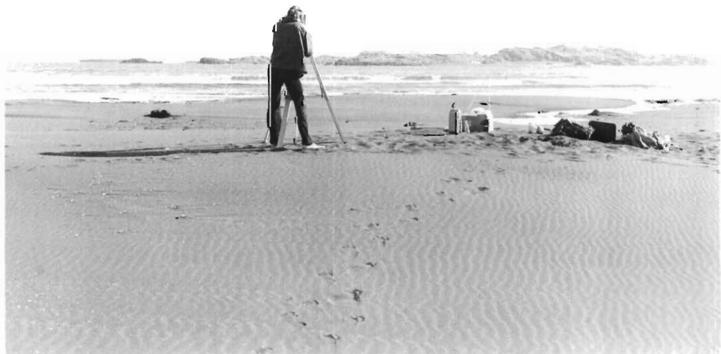
36.mynd: Hornstæðið ST.083 á sandinum í Stapaey. Horft yfir rúmlega 600 m breiðan Melrakkanesósinn yfir í Hrómundarey. Á þessari ótryggu undirstöðu þarf að reisa stálmastur.
