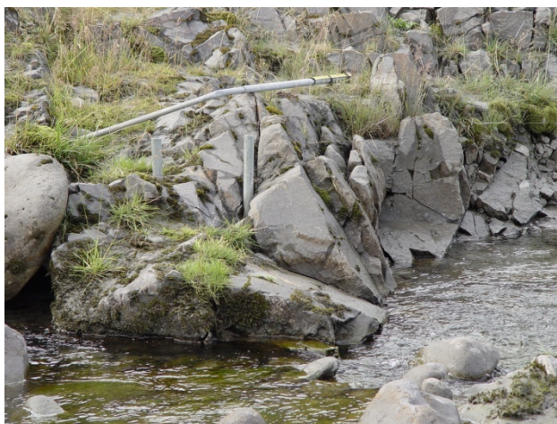
Mynd 2: Mælistaðurinn V530. Mælt var af tveimur lóðréttum rörum niður í vatnsborð. Mynd frá 19. ágúst 2004.
